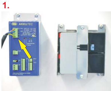
1. Anschluss des AKKUTEK an das Versorgungsnetz (230VAC)
