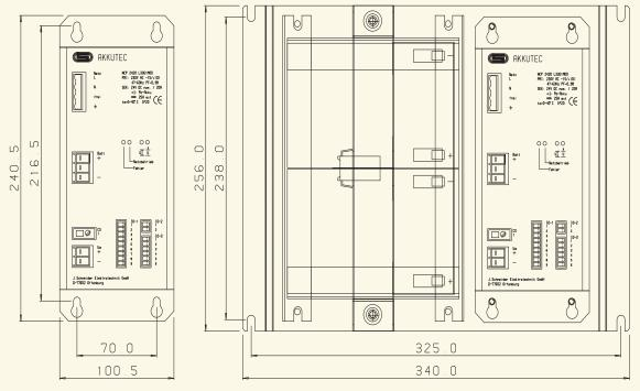
Einbautiefe : 244mm Einbautiefe : 252mm mounting depth : 244mm mounting depth : 252mm
