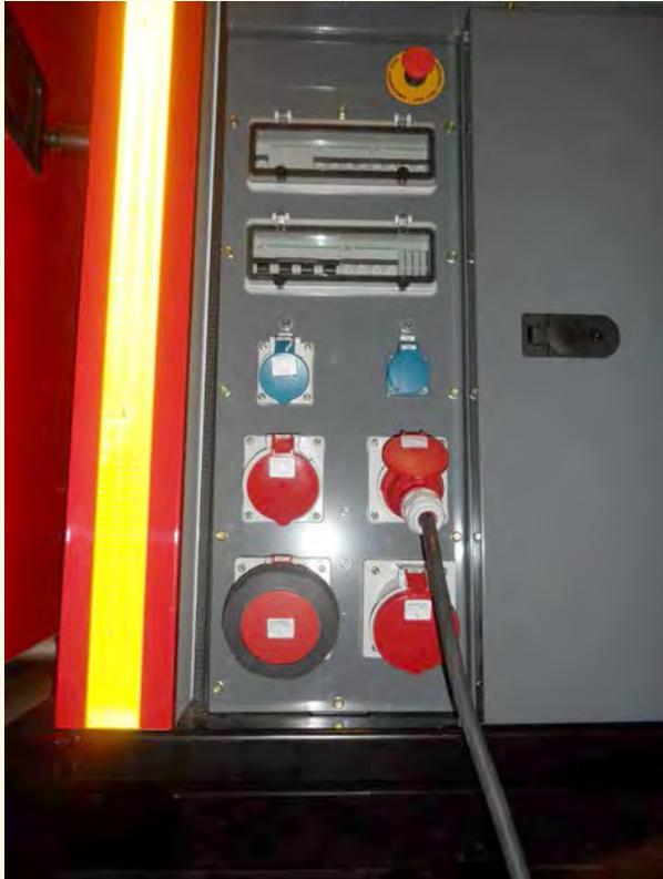
Anschlusskabel entnehmen und Verbindung zwischen Steckdosenfeld und Lichtmast herstellen, Sicherung Lima prüfen und einschalten!
