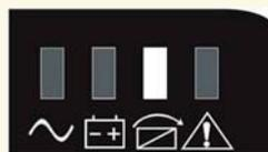
Die gelbe "Bypass"-LED leuchtet, der Summer ertönt einmal alle zwei Minuten. Die rote Alarm-LED ist eingeschaltet, wenn der Summer ertönt. Die Anzeige auf dem LCD-Display entspricht der genauen Last und der Akku-Ladung.
